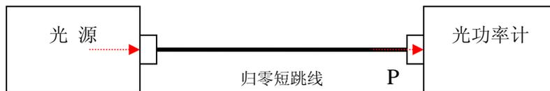
图 7.1.3-1 C 模式：先用短跳线归零
