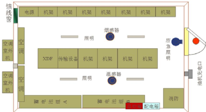
图 4.5.1-2 户外机房平面布置
