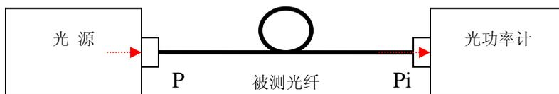
图 7.2.1-2 测试原理二：再测出光功率  $P_i$ ，则光纤链路衰减值= $P_o-P_i$
