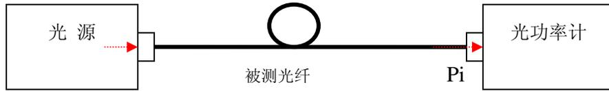
图 7.2.3-2 只测试光纤的衰减，不包含两端连接器的衰减，损耗值= $P_i$ (已归零)
