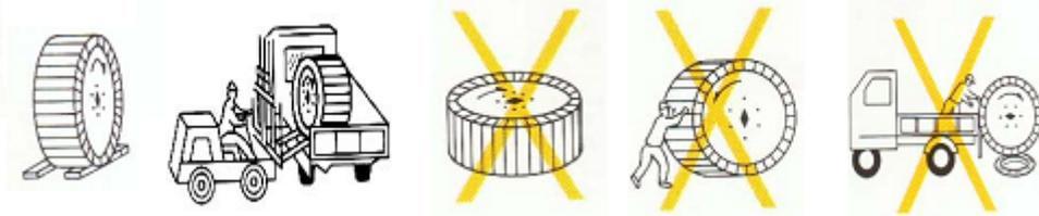
2) 运输光缆时，不得使缆盘处于平放方位，不得堆放；盘装光缆应按缆盘标明的旋转箭头方向滚动，但不得作长距离滚动；防止受潮和长时间暴晒；贮运温度应控制在-40~+60℃范围内。
