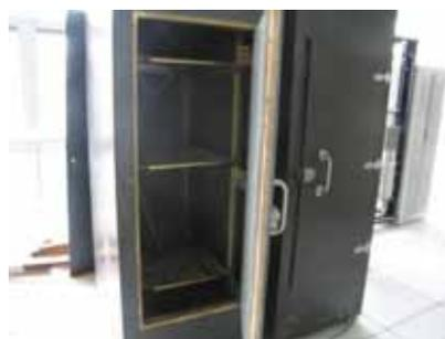
图 3.2 屏蔽机柜外形
