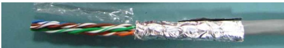
图 6.1 翻转后的铝箔完全覆盖了整个护套，不留任何缝隙
